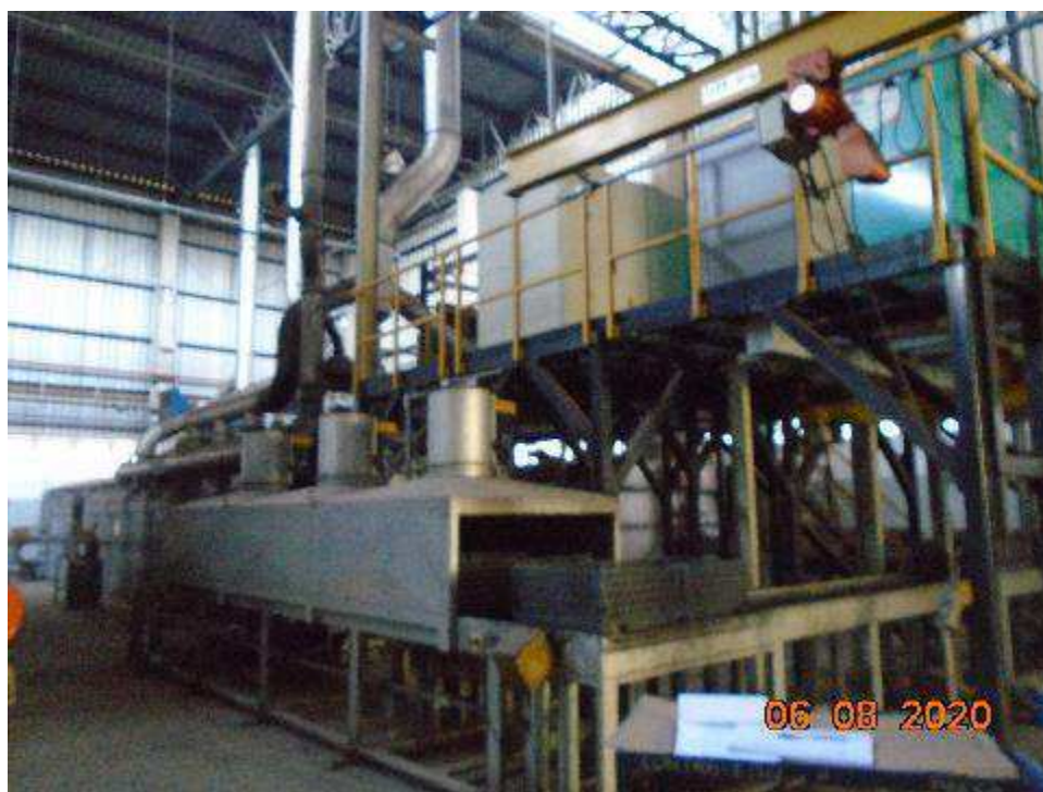
TAG 60-101 FORNO RECOZIMENTO
