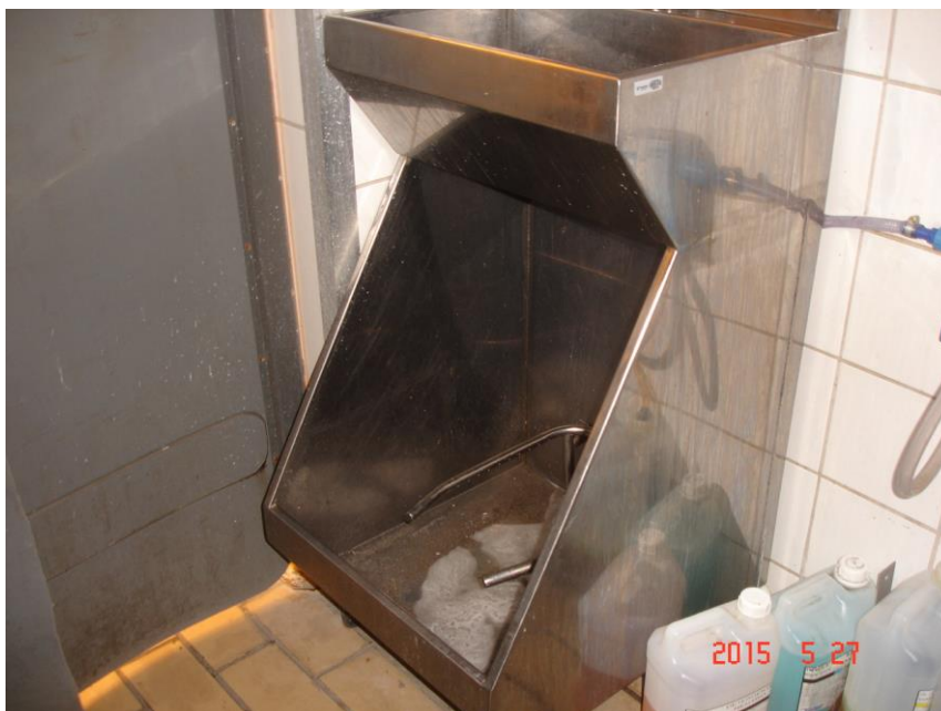
Vista do LAVATÓRIO DE BOTAS EM AÇO INOX, marca IMECA, para 01 BOTA. Patr. 00533
