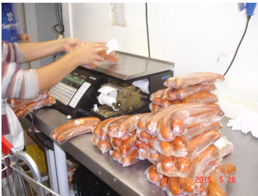
Vista da BALANÇA ELETRÔNICA, marca TOLEDO, modelo PRIX 5E/6, pesagem máxima 15 kg, mínima 04 g. ENDEREÇO 15, Patr. 00060
